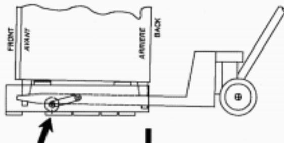
2. Pour retirer la machine de la palette, amener les roues avant sur la planche comme décrit.
