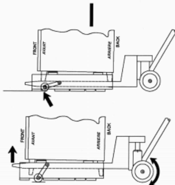
1. La machine doit être déplacée par l'arrière. Positionner les roues avant du transpalette comme décrit sur la figure à gauche avant de lever la machine et la palette.
