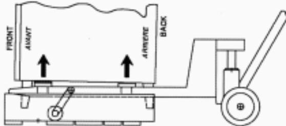
3. Actionner le bras d'élévation du transpalette. La machine et les deux planches supérieures doivent se séparer des montants verticaux de la palette.
